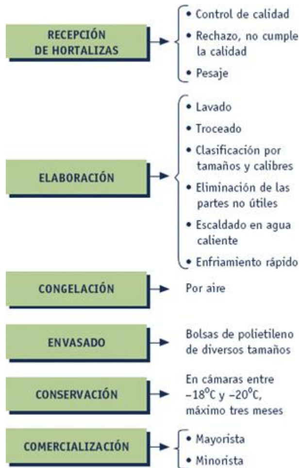
Figura 5. Proceso operacional de congelación (Ortí, Más, & Beorlegui, 2003).
